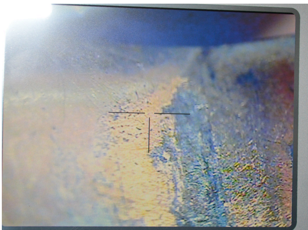
Présence de plaques d'or et marques de coulées préalables au forgeage
